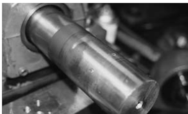
Cuscinetto fissato con viti dopo 500 ore
