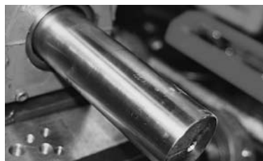
Cuscinetto fissato con viti dopo 2500 ore
